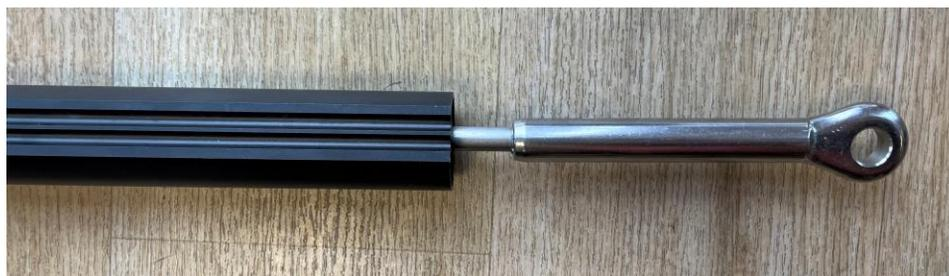
Si la coupe de longueur des gaines a bien été respectée et que la tourelle a bien été choisie en fonction de la terminaison du câble alors il doit rester un jeu entre l'extrémité de la gaine basse et le sertissage du câble.
