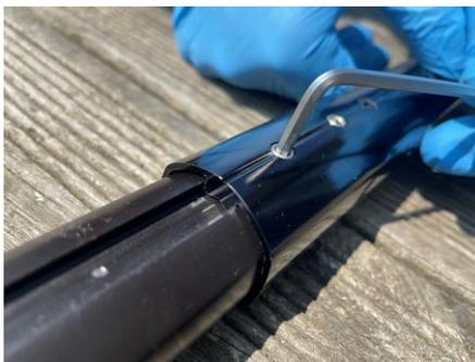
Récupérez dans le colis les vis de jonctions et la clé Torx, vissez avec un couple maxi de 5N.m, les vis ne doivent pas dépasser de la gaine.
