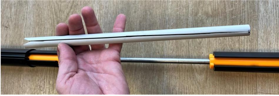
En vous aidant de l'échancrure réalisée dans le tube plastique fendu, faire rentrer le tube autour de l'étai entre les 2 éclisses
