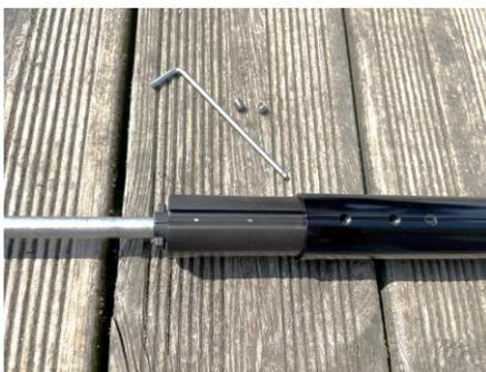
L'éclisse équipée des paliers vient s'insérer seulement de moitié (jusqu'à une vis faisant office de butée)
