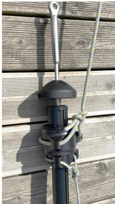
Accrocher une drisse sur l'émerillon et venir le mettre en butée sur la partie haute de l'enrouleur.
