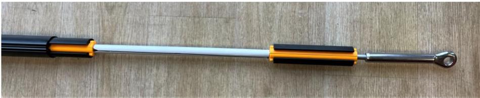
Ce tube plastique va empêcher l'éclisse de remonter et ainsi permettre l'installation de la gaine basse
