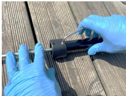
Insérez la butée haute et vissez la vis téton M8 inox (K) dans le perçage qui vient d'être effectué dans la gaine haute.
