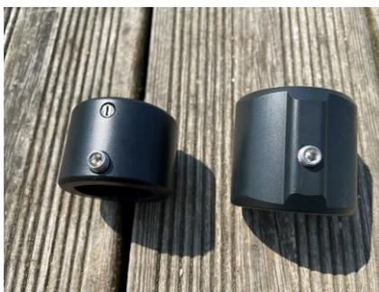
2 Types de butées existent, dans les 2 cas la vis inox est orientée vers le bas de l'enrouleur
