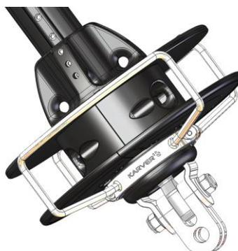
Montez l'axe fourni à travers les lattes, le cardan et la terminaison à œil de l'étai. Vissez en laissant un peu de jeu pour l'articulation du cardan.
