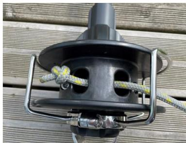
Des lumières au fond du tambour permettent de venir facilement accrocher avec un nœud simple l'extrémité du cordage de manœuvre.
